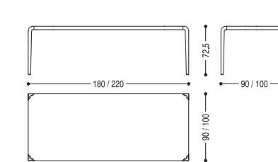
Tavolo interamente realizzato in legno massello con top a liste incollate sul quale, mediante un particolare sistema a coda di rondine, si incastrano le quattro gambe. Finitura: a base di olio/cera naturale di origine vegetale con estratti di pino.
