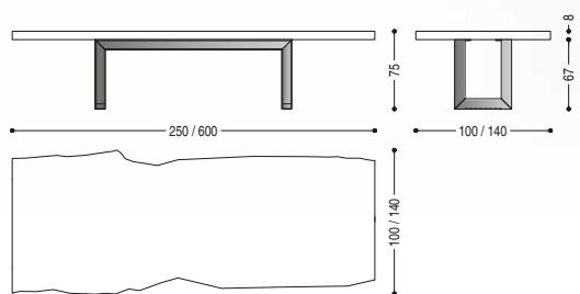
Tavolo realizzato con top in massello di Kauri, legno millenario della Nuova Zelanda e base geometrica in ferro con saldature a vista, che si ispira alla putrella (travetto di profilato metallico sagomato a doppio T). Finitura: a base di olio/cera naturale di origine vegetale con estratti di pino.
